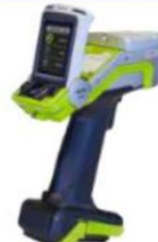
手持式 XRF 分析儀 X 光螢光技術 廢料回收/ 材料可靠性鑑別 (PMI)
